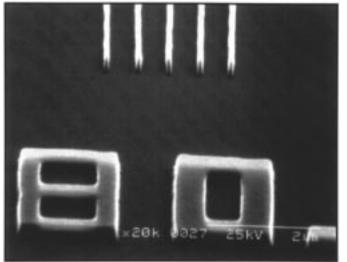
Fig. 11. 0.08-µm lines.
